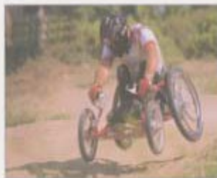
Foto n. 72 - 73 - Carrozze manuali con quattro ruote da mountain bike, adatte ad affrontare terreni particolarmente sconnessi e pendenze notevoli.
