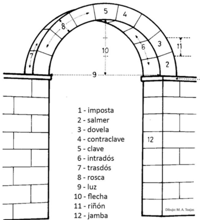
La manera en que están dispuestas las dovelas es el **despiece** (‘sezionamento’) del arco. El despiece **radial** es cuando las dovelas siguen los radios de un mismo centro. Y **despiece enjarjado** si se disponen horizontalmente hasta una cierta altura.
