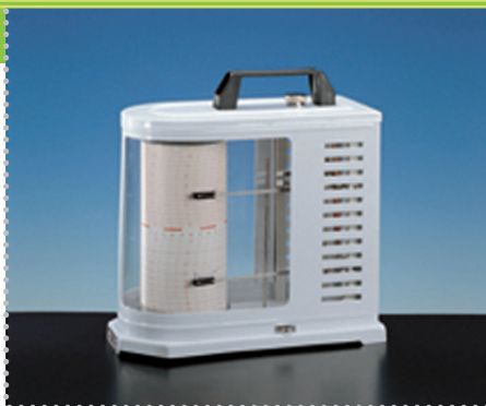
Fig 4.8 Termoigrografo registratore su carta. E' uno strumento meccanico con igrometro a capelli (UR) e termometro bimetallico. Due penne tracciano gli andamenti su un diagramma settimanale.
