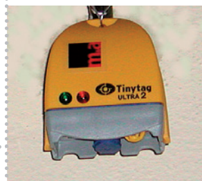
Fig 4.7 Termoigrometro mini-datalogger con 2 sensori T e UR interni; memorizza 32.000 dati.
